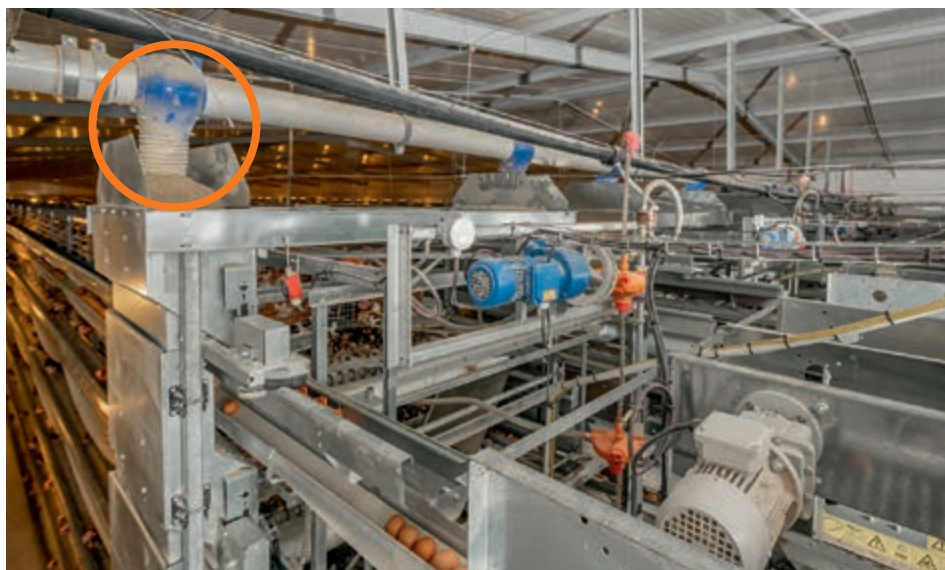
Конечный узел на переднем участке с приводом и загрузкой корма
