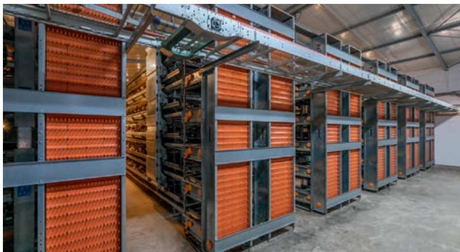
Пример батареи для кур-несушек UV 600, 6 ярусов с кормотележкой
