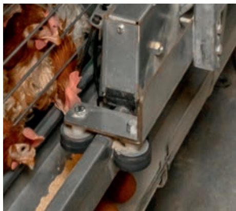
Прорезиненные ходовые ролики на шарикоподшипниках обеспечивают плавный и легкий ход кормотележки
