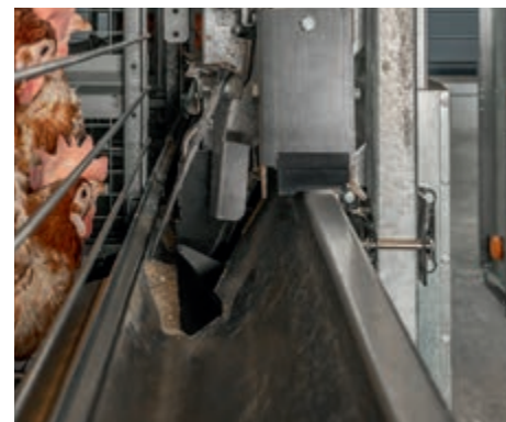
Стабильный V-образный кормлоток с функцией ступеньки
